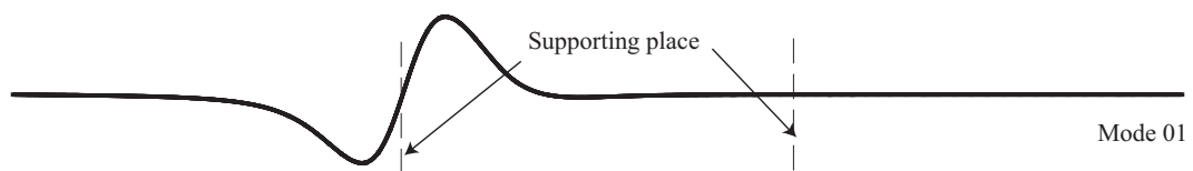
(c) 2D モデルによる座屈モード
