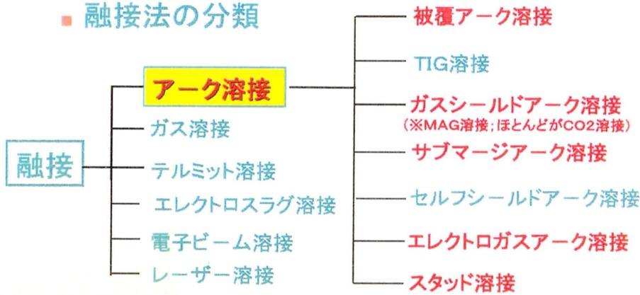
■ アークを熱源とする融接、すなわち **アーク溶接** が最も広く用いられ特に **鋼橋** では各種の溶接法が採用されている
