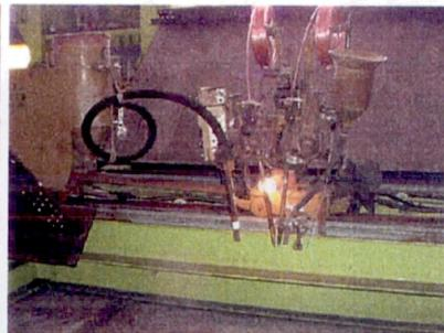
タンデムSAW溶接装置
