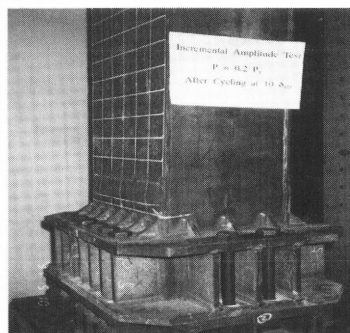
写真 20.3.4 実橋タイプ橋脚における脚の母材のクラック
