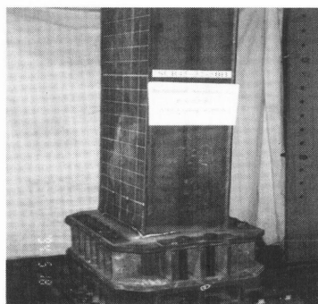
写真 20.3.4 実橋タイプ橋脚における脚の母材のクラック
