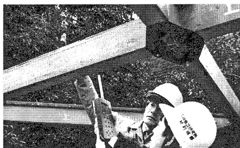
写真-3 打撃法による部材 MOE の測定方法
