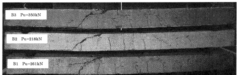
写真-1 破壊したはり供試体
