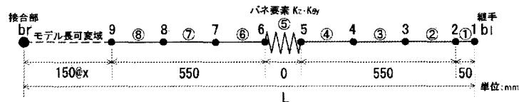
図-11 実橋曲げ打撃試験要素分割図
