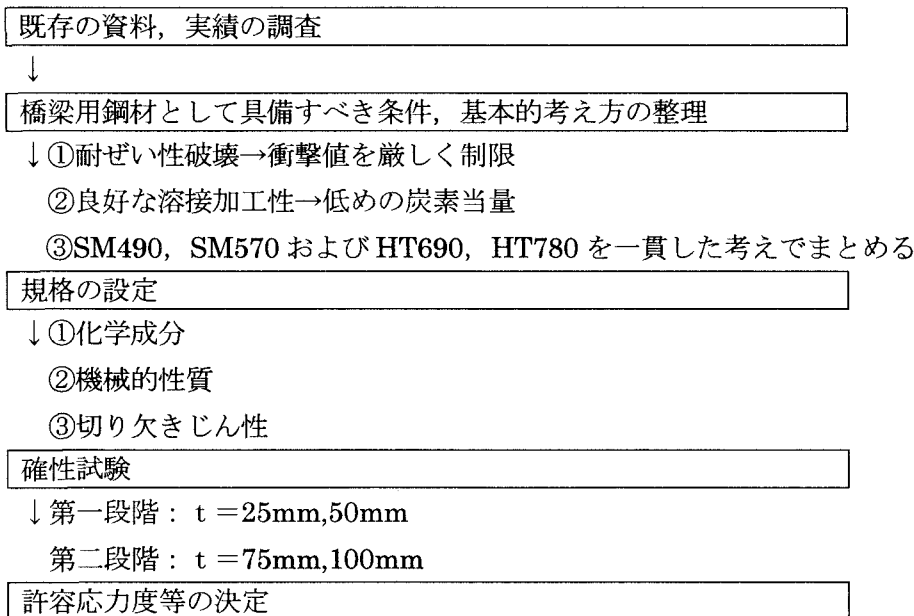
図 3.3 港大橋での高強度鋼に関する検討フロー
