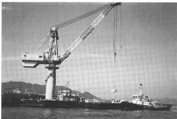
写真 A5.4.5 全回転式浮きクレーン
