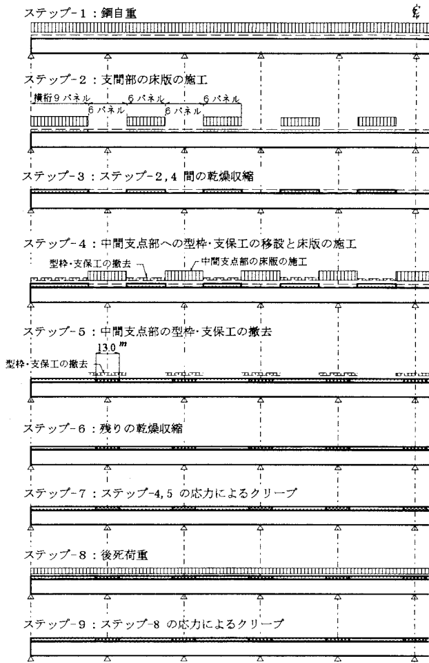
図-3 施工手順と計算ステップ
