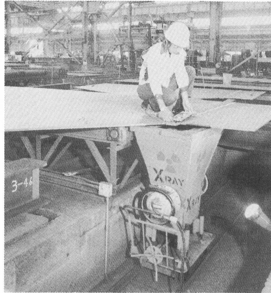
写真 9-2 放射線透過検査状況
